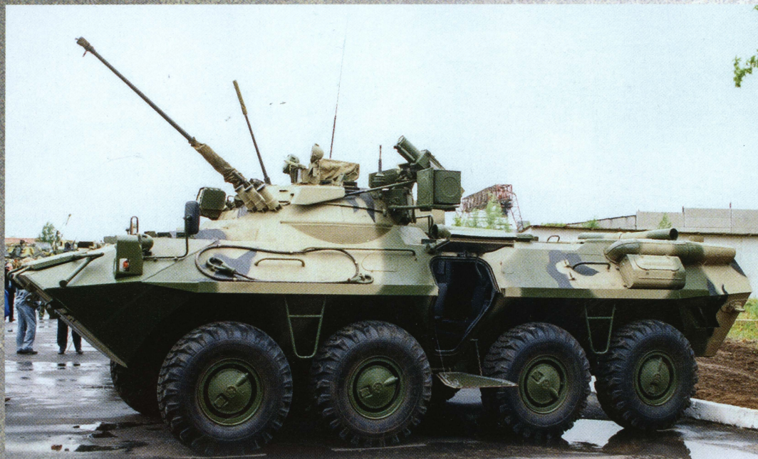
Один из первых образцов бронетранспортера БТР-90 «Росток», вид слева. Водометные движители размещены внутри корпуса.
