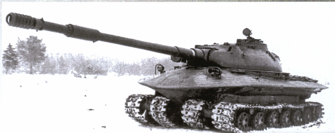
Опытный тяжелый четырехгусеничный танк «объект 279», общий вид.
