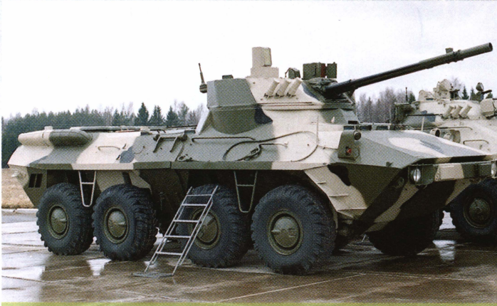
Бронетранспортер БТР-90 с комплексом вооружения «Бахча-У», общий вид.
